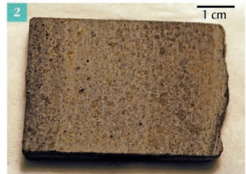
Étape 2 : surfaçage d'une des faces du talon sur rodeuse
