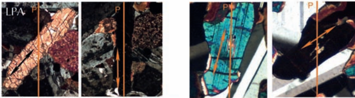
a) Extinction droite de l'orthopyroxène par rapport au prisme et à la direction de clivage (double flèche rouge). P: plan du polariseur en jaune.
