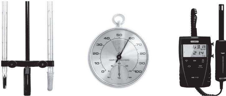
Figure 5.1 Psychromètre et hygromètre à cheveu et numérique
