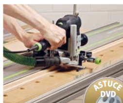
70 Utilisation du rail de guidage
