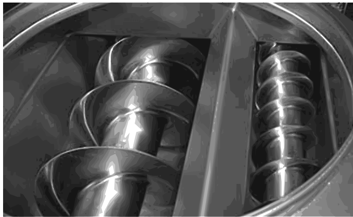
Figure 6.1 Contrôle fin et grossier à deux vis sans fin
