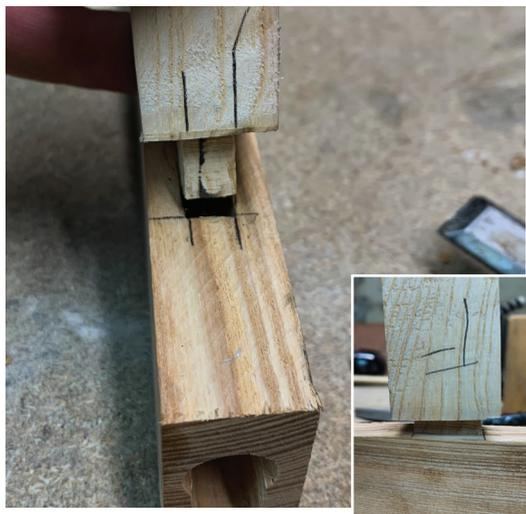
**5** Une fois fini, le tenon doit s'adapter parfaitement à la mortaise, sans forcer.
